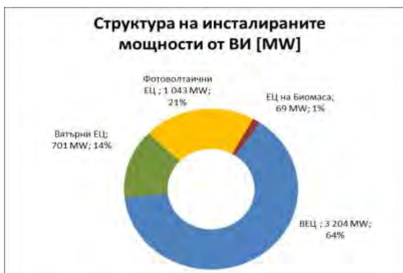
Фиг. 2 - Процентно разпределение на инсталираната мощност по типове централи по данни на ЕСО ЕАД
